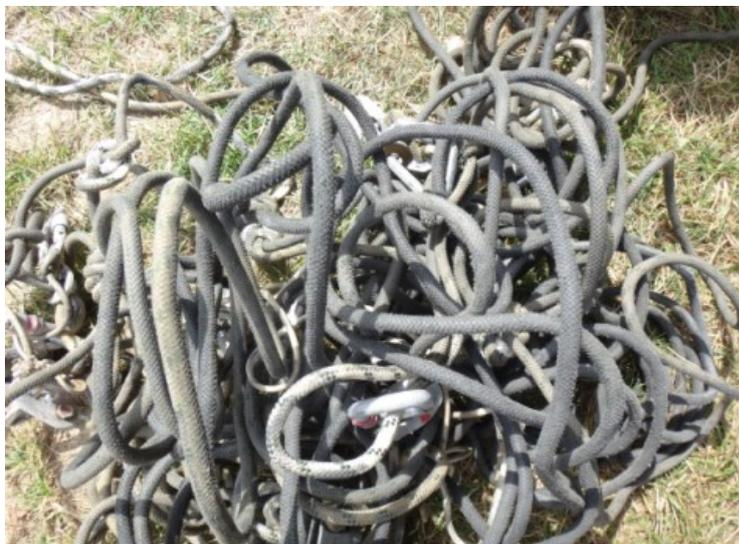
Pour l'équiper jusqu'au fond, et en double jusqu'à -250 m, il ne faut pas moins de 200 mousquetons, 150 plaquettes, 100 mètres de cordelette et sangles, et... 1400 mètres de cordes de progression. Quand on sait qu'après plus de 300 passages, la grande majorité des longueurs de cordes est bonne pour la poubelle - voire pour certaines verticales, doivent être changées avant la fin du rassemblement - on comprend que l'investissement matériel est conséquent.
