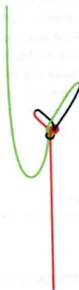
**Dans le cas du nœud de chaise double, uniquement si la corde en aval est libre** (dernier jet d'un puits ou spéléologue en situation d'équipement) et si le spéléologue est longé sur le brin rouge de la ganse du nœud en Y, la corde aval peut glisser dans le nœud et aller jusqu'à entraîner la chute du spéléologue (voir les tests du DPMC sur le nœud de chaise double). C'est le seul cas où se longer dans une seule ganse du nœud peut être vraiment dangereux.
